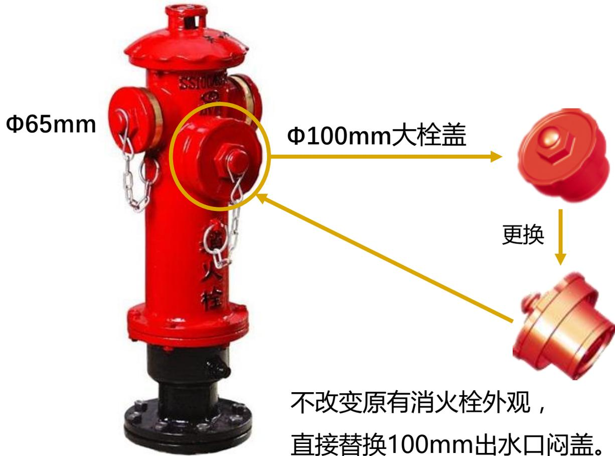
若有人在100mm出水口用水，在拧动消防栓防盗水报警装置时，装置中的倾斜开关发生位置偏离并导通，触发报警装置，将报警信息通过NB-IoT网络远传至监控中心，实现及时报警。
